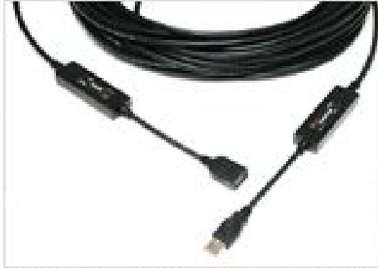
Opticis(オプティシス)社製 光 USB 延長ケーブルは、従来 5m 程度であった銅線の USB ケーブルの伝送距離を 40m まで、リピーターを使わずに延長可能します。ホストから USB 対応機器までの接続をシンプルに経済的に延長することが出来ます。先端光技術を駆使し VCSEL レーザー、フォトダイオード、USB プロトコルにより、40m もの長距離伝送を可能にしました。光ケーブルの両端に光-電気、電気-光変換モジュールが接続されています。A プラグから A レセプタクルは(M2-100)、A プラグから B プラグは(M2-110)の 2 種類を用意。Windows 及び Mac 用の他に Sun Solaris 用もあります。
