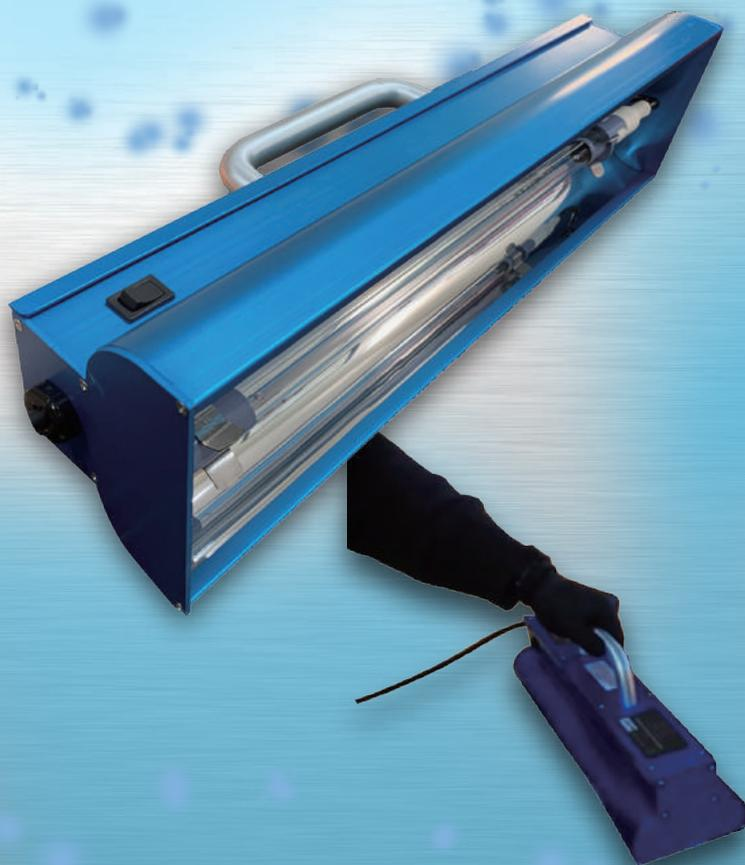
UVC ブレードは手持ち式のポータブル UVC（波長 200-280nm）消毒・殺菌デバイスです。バクテリアやウイルス、菌類を不活化します。American Ultraviolet 社独自の HO ランプは水晶ガラスとより堅牢な電極を使用し、高効率と長寿命を実現しています。
