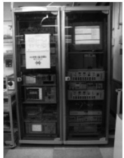
図1 データベース付集中型計測システム。ラクスパートのEDFA製造工程は、融着機を使ったアセンブリ工程と集中型計測システムを使ったテスト工程で構成されている。一般的なEDFAメーカーのように、各作業テーブルに測定器セットを配置することをせず、作業テーブルが10台あっても、測定系はこの集中型計測システムのみで行う。測定時間は、短いものが多いので、CAPEX削減、OPEX削減に大きく貢献することになる。加えて、このシステムにはデータベースが搭載されており、収集したデータはトレーサビリティ、製品の改善に役立てる。
